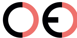
Falsche CE-Kennzeichnung (zu großer Zwischenraum)
